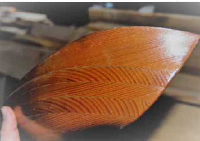
Puolimallista veneenveistäjä osasi siirtää veneensä piirustukset luonnollisessa koossa pinkopahville.
